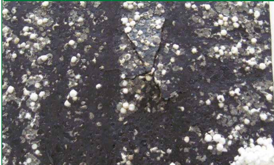
FACCIA INFERIORE CON ROTTURA A "STELLA"
