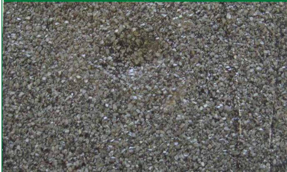
FACCIA INFERIORE CON ROTTURA A "STELLA"
