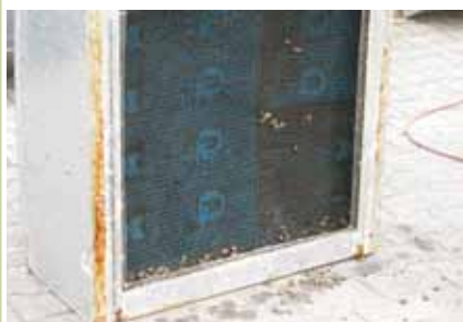
9. Faccia inferiore di DEFEND H inalterata dopo il test
