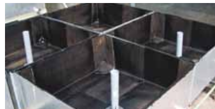
2. Vasche di prova impermeabilizzate
